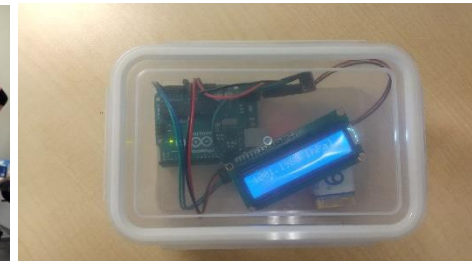
電子回路で構成した 温度・湿度・気圧計
