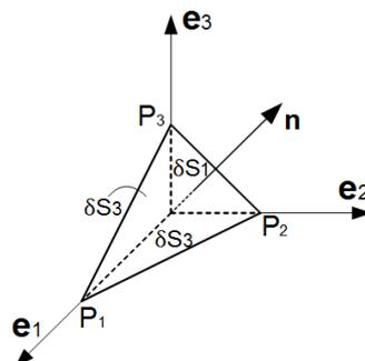
図 2.4 座標軸に垂直な 3 つの面を持つ微小な四面体
